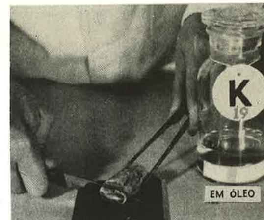
Fig. 6-6 - O potássio é mole - pode ser cortado com uma faca.
