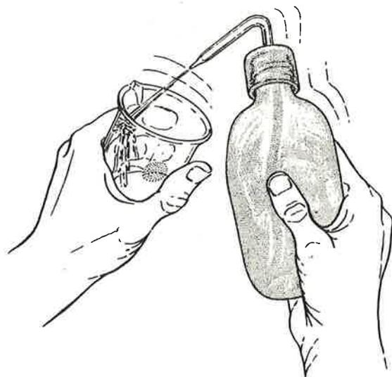
Fig. 8-3 - Lavando o béquer com o frasco apropriado.
