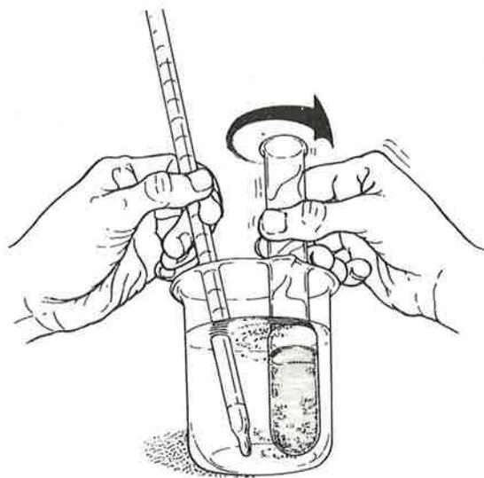
Fig. 5-5 — Determinando o calor de solidificação.
