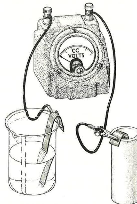
Fig. 21-1 – Montagem de uma célula eletroquímica utilizando um copo poroso.
