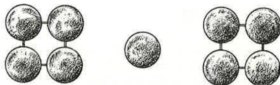
Fig. 27-3 — Camadas para o empacotamento cúbico de corpo centrado.
