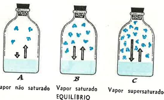
Fig. 9-3 - Intercâmbio de moléculas entre líquido e gás: (A) a pressão parcial é inferior à pressão de vapor; (B) há equilíbrio; (C) a pressão parcial é mais alta do que a pressão de vapor.
