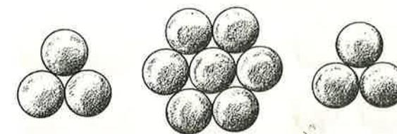
Fig. 27-1 — Camadas para o empacotamento hexagonal denso.
