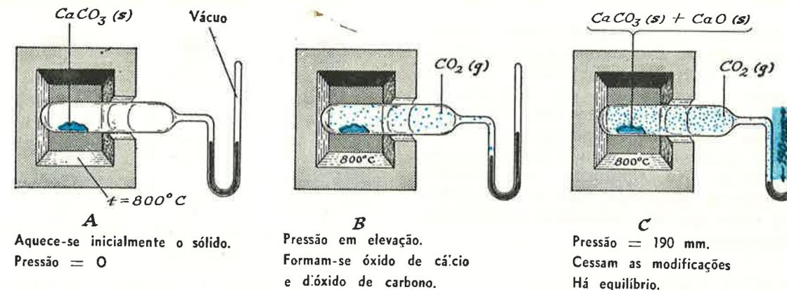
Fig. 9-2 — Decomposição térmica do carbonato de cálcio:  $\text{CaCO}_3(s) \rightleftharpoons \text{CaO}(s) + \text{CO}_2(g)$
