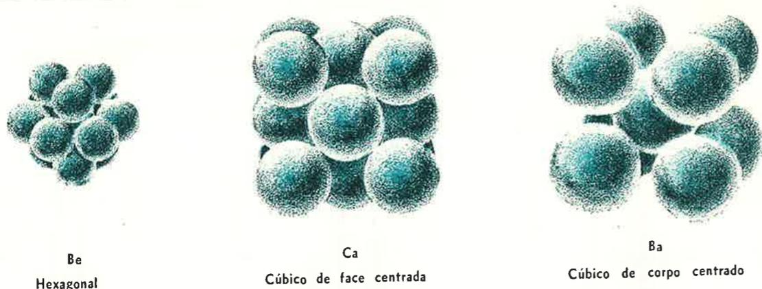
Fig. 21.2 — Representação em escala das estruturas cristalinas de Be, Ca e Ba.
